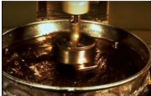
Figura 778 - 3. Ensamble de la cabeza de caucho abrasiva
